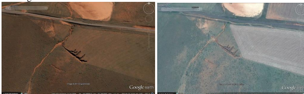
Figura 2: Evolução do processo de erosão no município de Manoel Viana-RS entre 2004 (A) e 2013 (B). Fonte: Google Earth.
